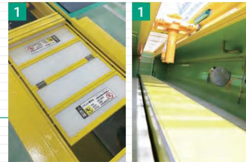
▲完成検査ラインの“フロアリフト”にはピット転落防止パネル“エフオール セキュリティ”を完備し転落事故防止と作業負荷軽減を両立
