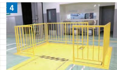
▲1枚目のリフターを幅広仕様にした“3分割フロアリフト”はミッションなどの重量物を上げるために採用。安全柵を常設し転落防止に対応
