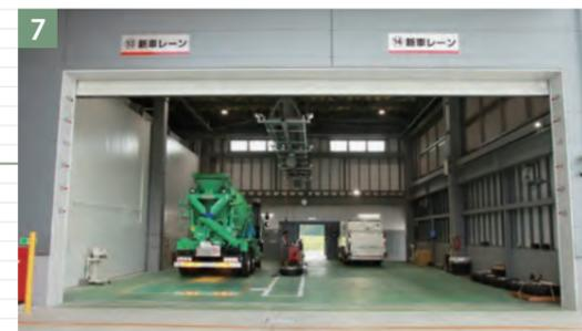
▲完成検査ラインとは別に新車ストールを採用したことで、完成検査ラインの渋滞を解消。左側には“フロアリフト”と“軸重計”を納入し、右側はエーミング用スペースを設けた
