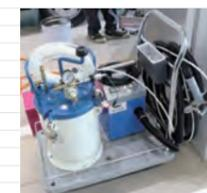
▶下回りの塗装に用いる温風低圧塗装機を設備。温風によるエアで塗装をするため速乾性が高く、塗着効率は90%。作業場内への塗料粒子の飛散を大幅抑制
