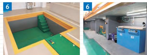
▶“3分割フロアリフト”の1枚を広くすることで、エンジンの脱着作業を容易に。ピット内にドレンキャビネットを設置することで、廃油処理もピット内で完結。作業時間の短縮とメカニックの負担が軽減
