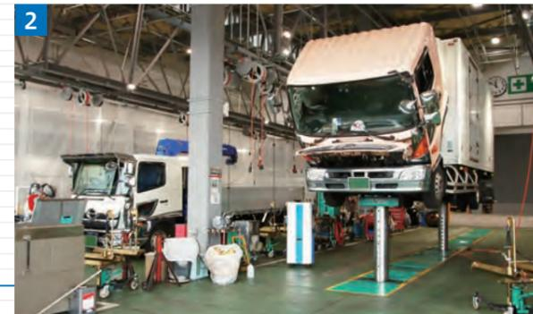
▲“4柱式ツインパワーリフト”は全移動タイプのためセッティングがラクになり時短に貢献
