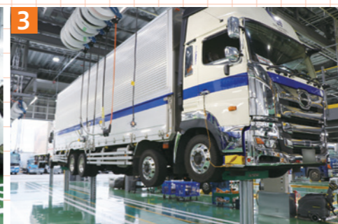
▲分解整備スツールはスルーレーンを採用。さらに、バリエーション豊富なリフトを納入したことで大型トラック、小型トラックの縦列整備を可能にし、作業効率が向上
