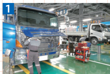
◀一般整備は1柱・2柱リフトへの転換で疲労を軽減
