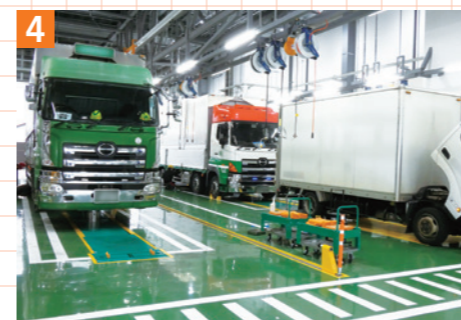
▲分解整備スツールはスルーレーンを採用。さらに、バリエーション豊富なリフトを納入したことで大型トラック、小型トラックの縦列整備を可能にし、作業効率が向上
