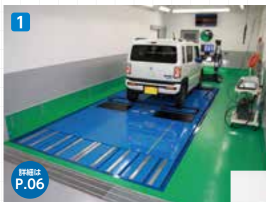
1 “4WD対応ABSテスター”を導入した完成検査ライン。前輪のセット完了後、後輪の位置に合わせてテスターが移動
