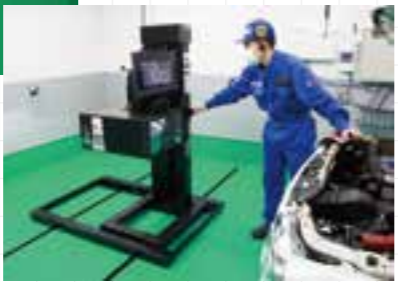
“手動式前後移動ヘッドライトテスター”の採用でセッティングの時間短縮に貢献
