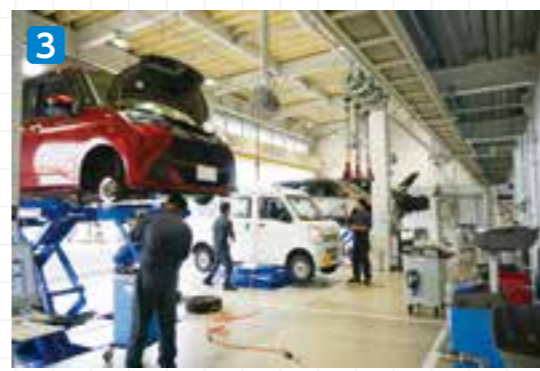
3 乗用車の整備工場は全6ストール。“マルチアライメントリフト”1基、“ファンタスIIリフト”3基、そして“アヴェンタスリフト”を2基設備
