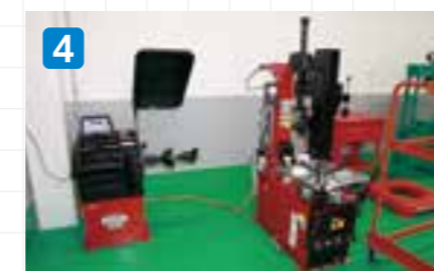
4 ホイールバランス“neo221”は作業時の事故を防ぐため、オプションの“ホイールカバー”を採用
