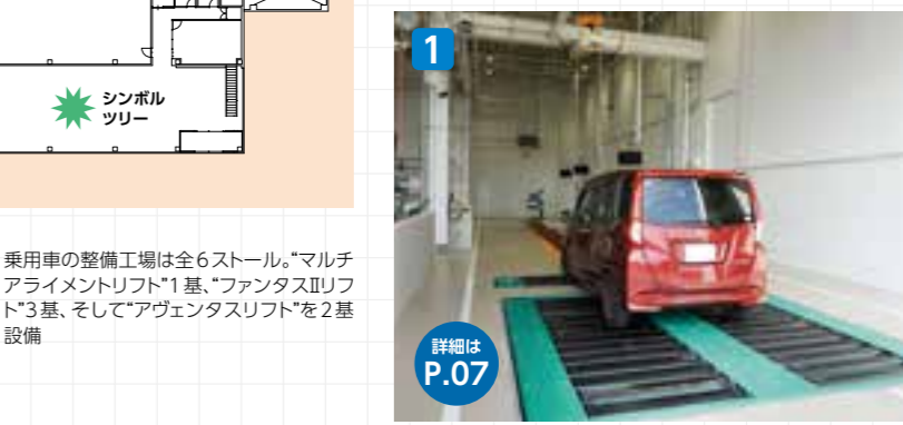
1 検査ラインは乗用車・大型車の兼用。降雪地域により4WD車の需要が多く“多軸フリーローラー”も両車兼用
