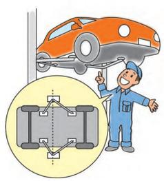
振動でアタッチメントが外れ、車両が落下する危険があります。自動車メーカーが指定するリフトポイントにセットしてください。
