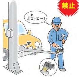
使用中に破損しアタッチメントが外れ、車両が落下する危険があります。アタッチメントは消耗品です。定期的に交換してください。
