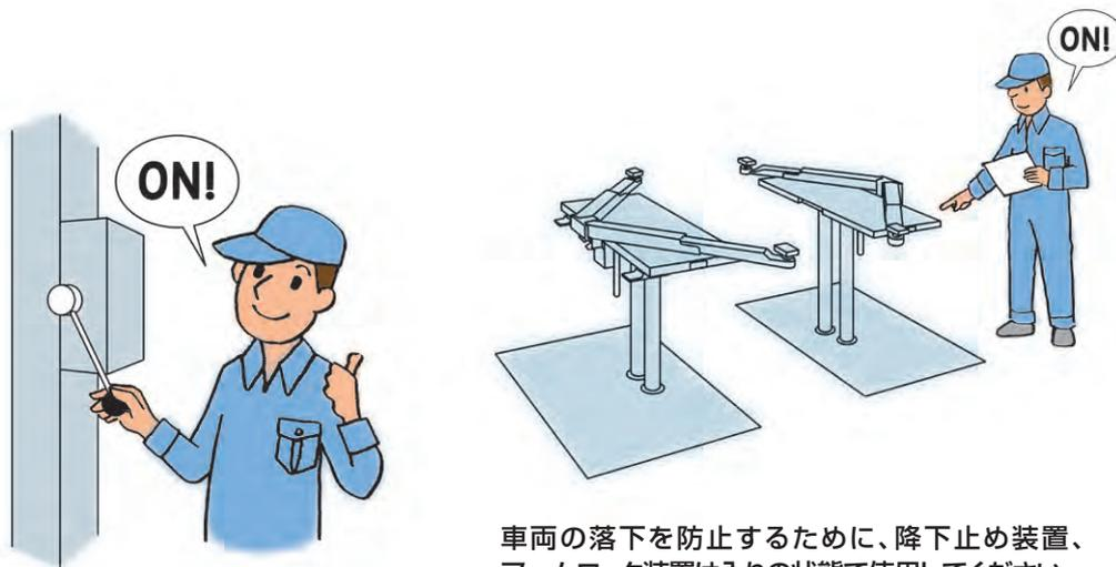
車両の落下を防止するために、降下止め装置、アームロック装置は入りの状態で使用してください。
