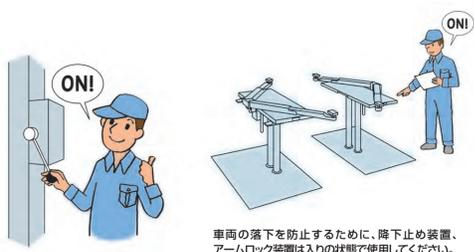
車両の落下を防止するために、降下止め装置、アームロック装置は入りの状態で使用してください。
