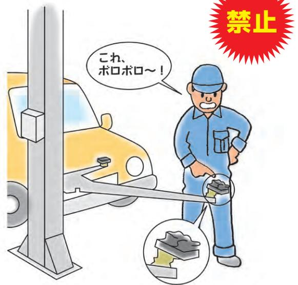
使用中に破損しアタッチメントが外れ、車両が落下する危険
