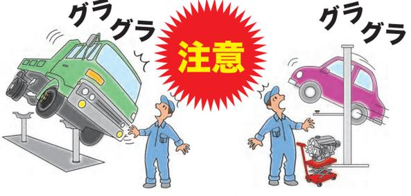
極端な偏荷重や重量物の脱着による荷重バランスの崩れに注意しましょう。
