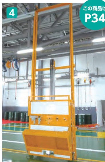
大型車の上部整備の際、安全性を高める ためにエア式アクセスリフトを採用
