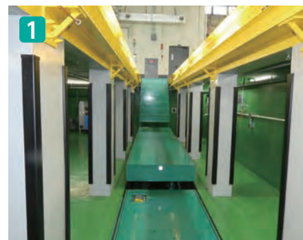
クイック整備には2分割フロアリフトで対応。地下空間は収納兼作業スペースとして有効活用
