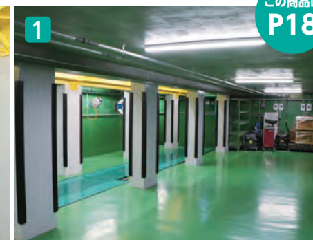
クイック整備には2分割フロアリフトで対応。地下空間は収納兼作業スペースとして有効活用
