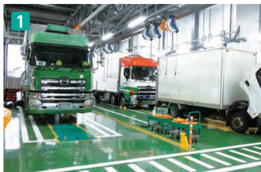
大型トラック、小型トラックの縦列整備を可能にするツインパワーリフト
